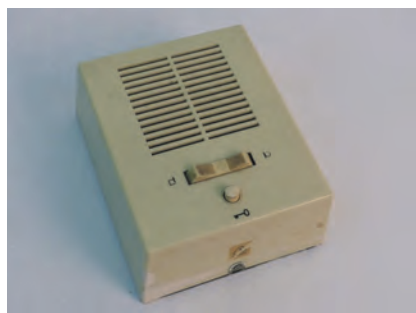
Sprechanlage mit Türöffner von 1965
