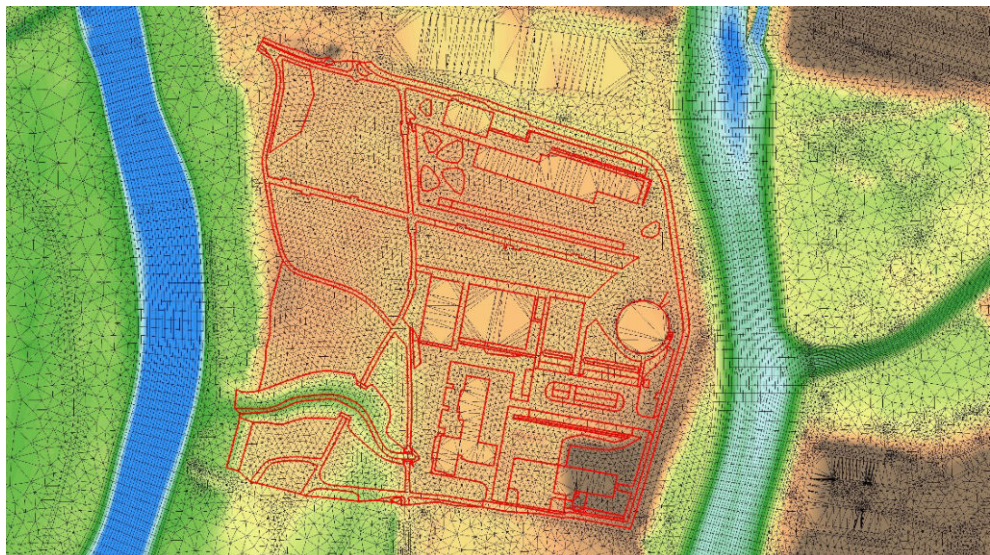
Abbildung 4.2: Aktualisierung Höhenmodell im Bereich Holzplatz /3/ (rote Linien = Bruchkanten DGM)
